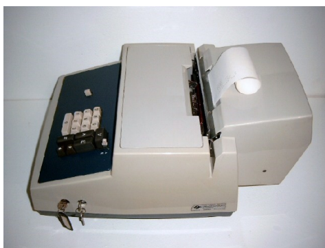
Kienzle 102 K, Schalterquittungsmaschine mit Vorsteckeinrichtung für Kassenbelege
