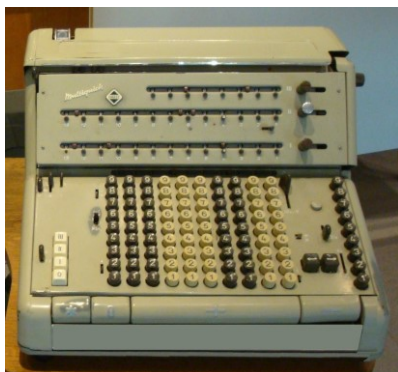
Vierspezies-Rechner Modell Badenia TAV 13 Duplex der Firma Mathias Bäuerle GmbH, St. Georgen
